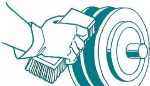
N.B.: desligue e bloqueie a alimentação do motor antes de iniciar a limpeza ou reparação.
