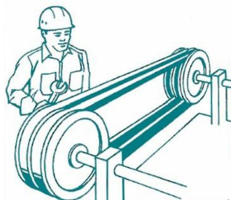
Após a instalação das correias inspeccionar a transmissão e observar enquanto funciona.
