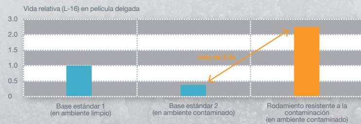
Timken ofrece ahora rodamientos resistentes a contaminantes. La gráfica superior compara rodamientos Timken® estándar operando en ambos ambientes, limpios y contaminados. Estos datos demuestran una mejora significativa en la operación de los rodamientos especiales en el ambiente contaminado.
